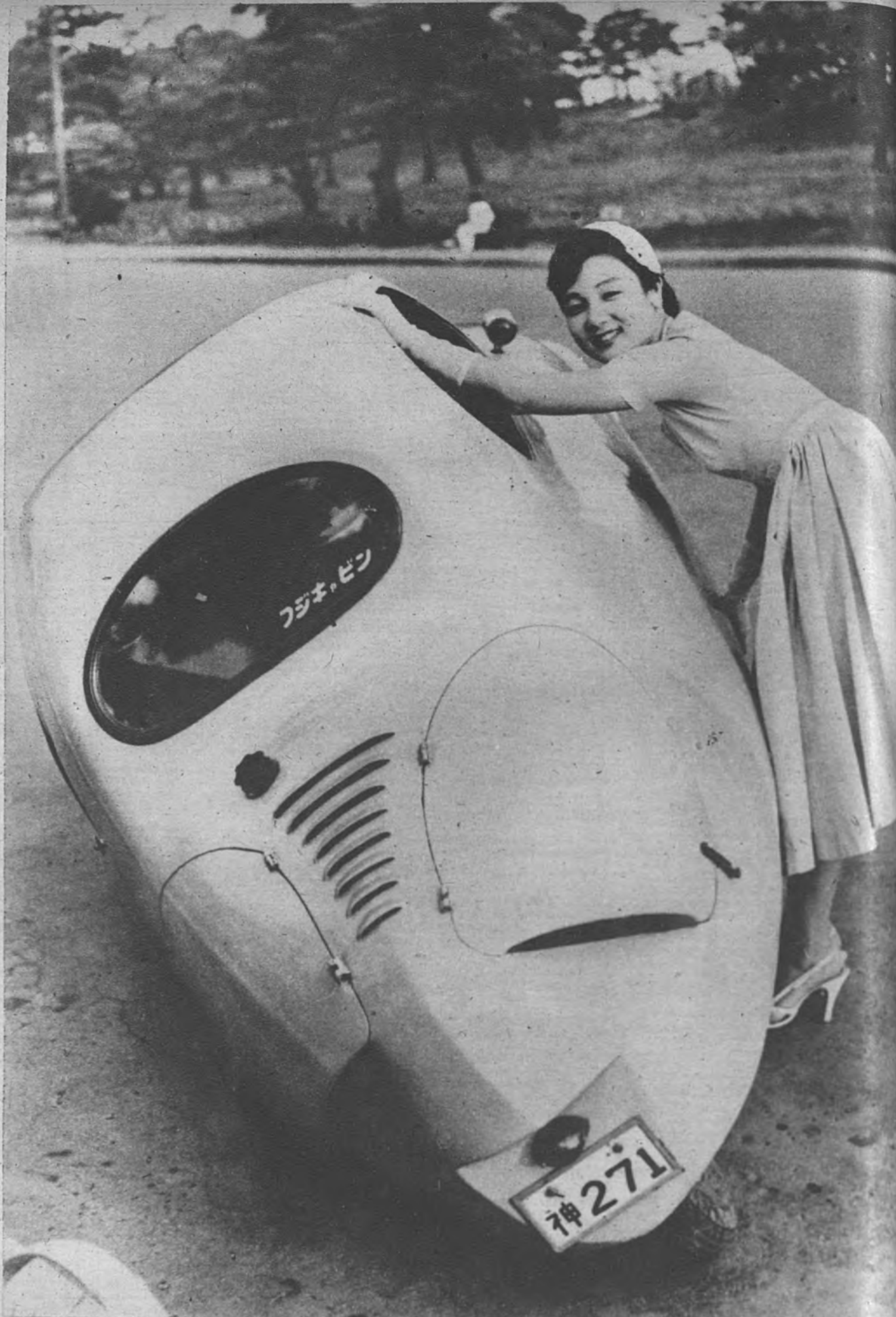
COCHE UTILITARIO JAPONES. —Los japoneses han sido siempre especialistas en cosas diminutas y delicadas. Ahora han fabricado, de acuerdo con sus tradiciones, este coche utilitario con el nombre de «Fuji Cabin». Pesa unos 140 kilos y lleva un motor de 5,5 HP. Alcanza una velocidad de 60 kilómetros. La demostración de su ligereza la hace una modelo de Tokio, que en la foto aparece volcando el pequeño vehículo. — (Foto Keystone.)
