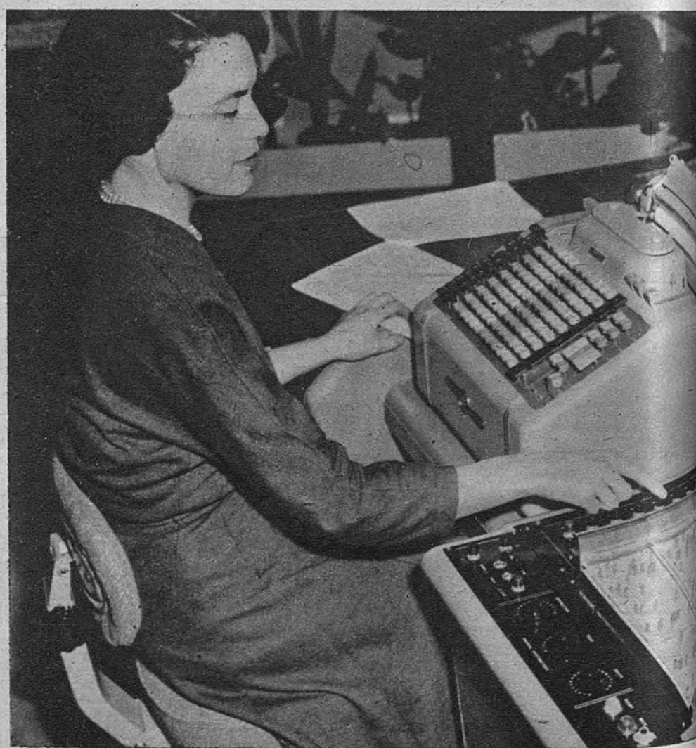
CEREBRO ELECTRONICO. —Este aparato es el nuevo cerebro electrónico llamado "Baby Brain". Se trata de una máquina contable, y entre sus muchos usos destaca su utilización en trabajos científicos y de ingeniería. El "Baby Brain" se fabrica en Norteamérica y resuelve las cuestiones más difíciles en muy pocos segundos.
