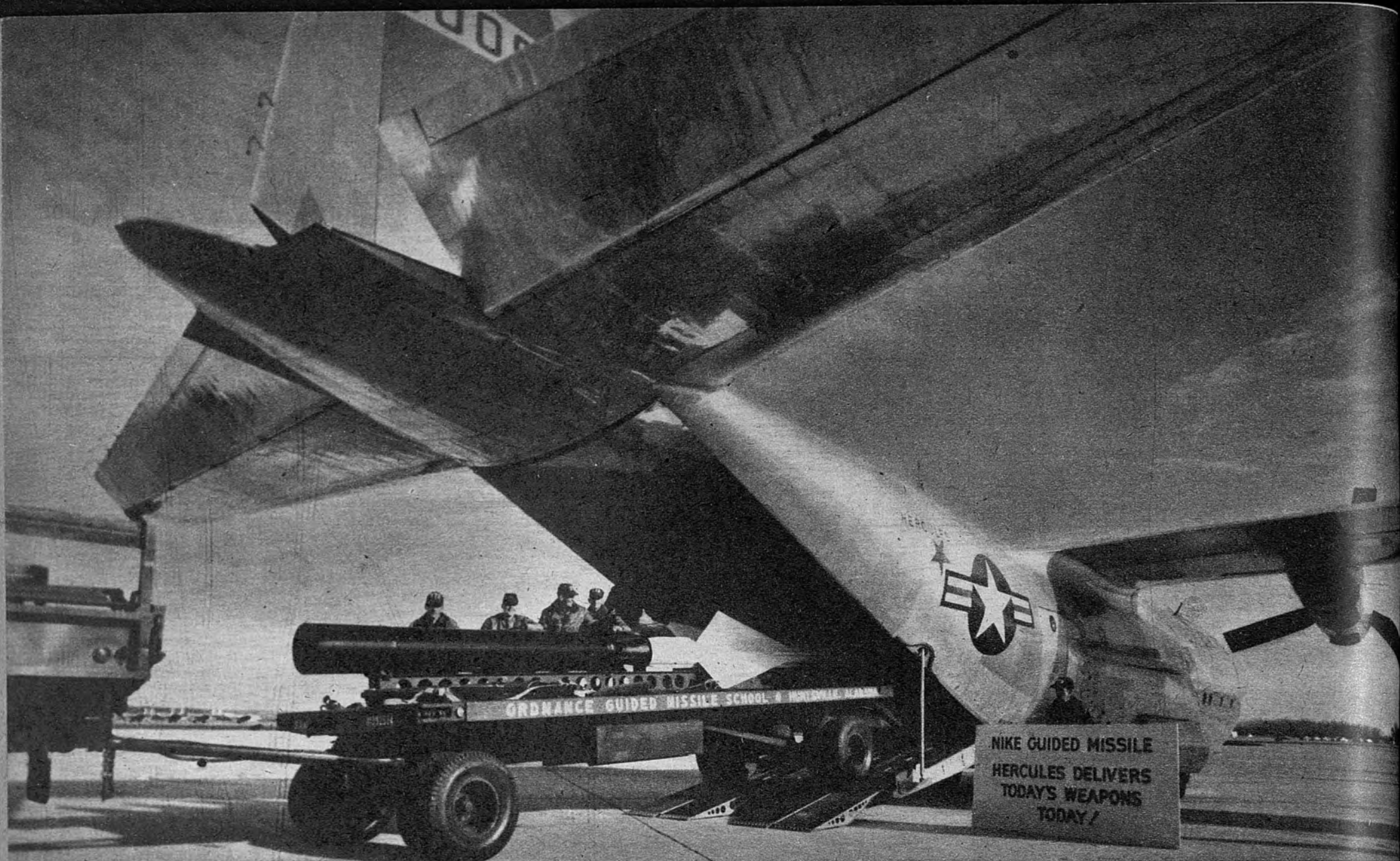
CON PROYECTIL A BORDO. —Un proyectil teledirigido "Nike" es cargado en el avión "Lockheed C-130 Hércules", de transporte de guerra, que acaba de ser probado por la Aviación norteamericana. El avión es el primero de la serie "Propjet" y va equipado con una dotación de motores de propulsión y de hélice
