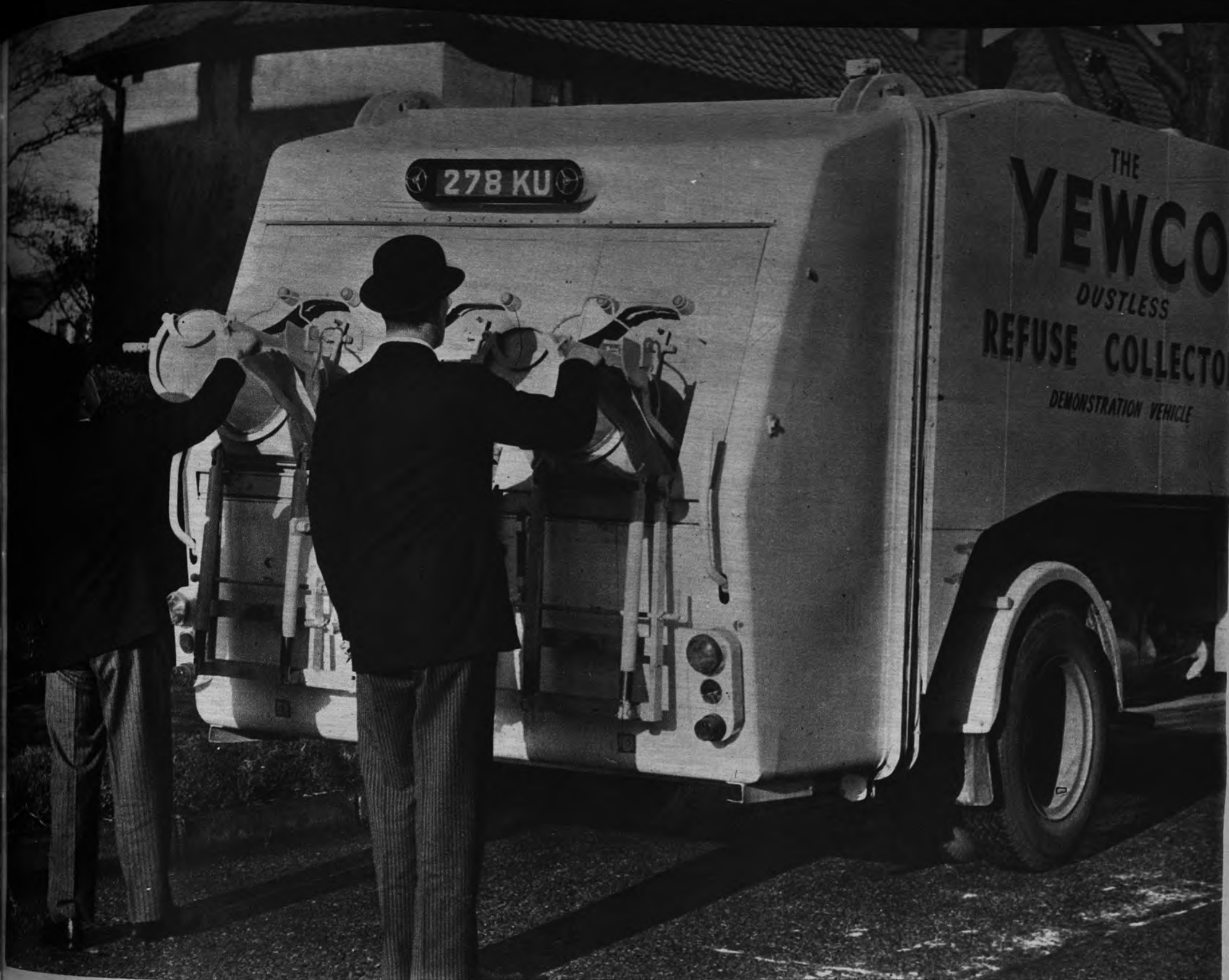
hermético y mecánico de la descarga, que es el sistema propuesto denodadamente para Madrid contra tantas y persistentes resistencias, permite efectuar el trasiego de los desperdicios sin que una sola partícula de basura entre en contacto con el ambiente y sin necesidad de operaciones e indumentos humillantes o indignos para quienes han de realizar los trabajos propios que requiere este indispensable servicio público bien organizado. — (Fotografías de Cifra.)
