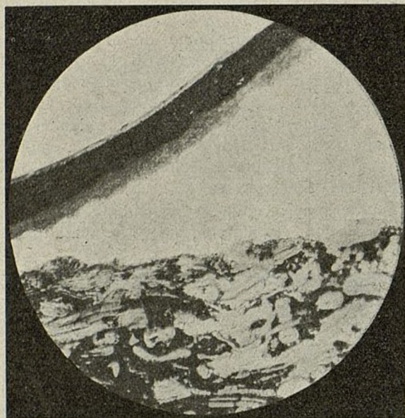
Papel bromuro brillante gelatinado cuyas fibras se han desprendido, \times 250
