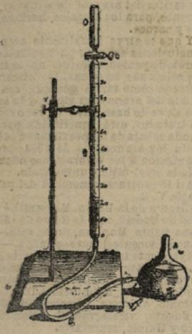
Se empieza por echar agua en el matraz A, hasta la altura que indica la figura próximamente, estando abierta la llave e. Después se eleva dicho matraz para que el agua pase por el tubo de caucho B al tubo graduado C, cerrando la llave o en el momento en que se haya llenado este tubo.
