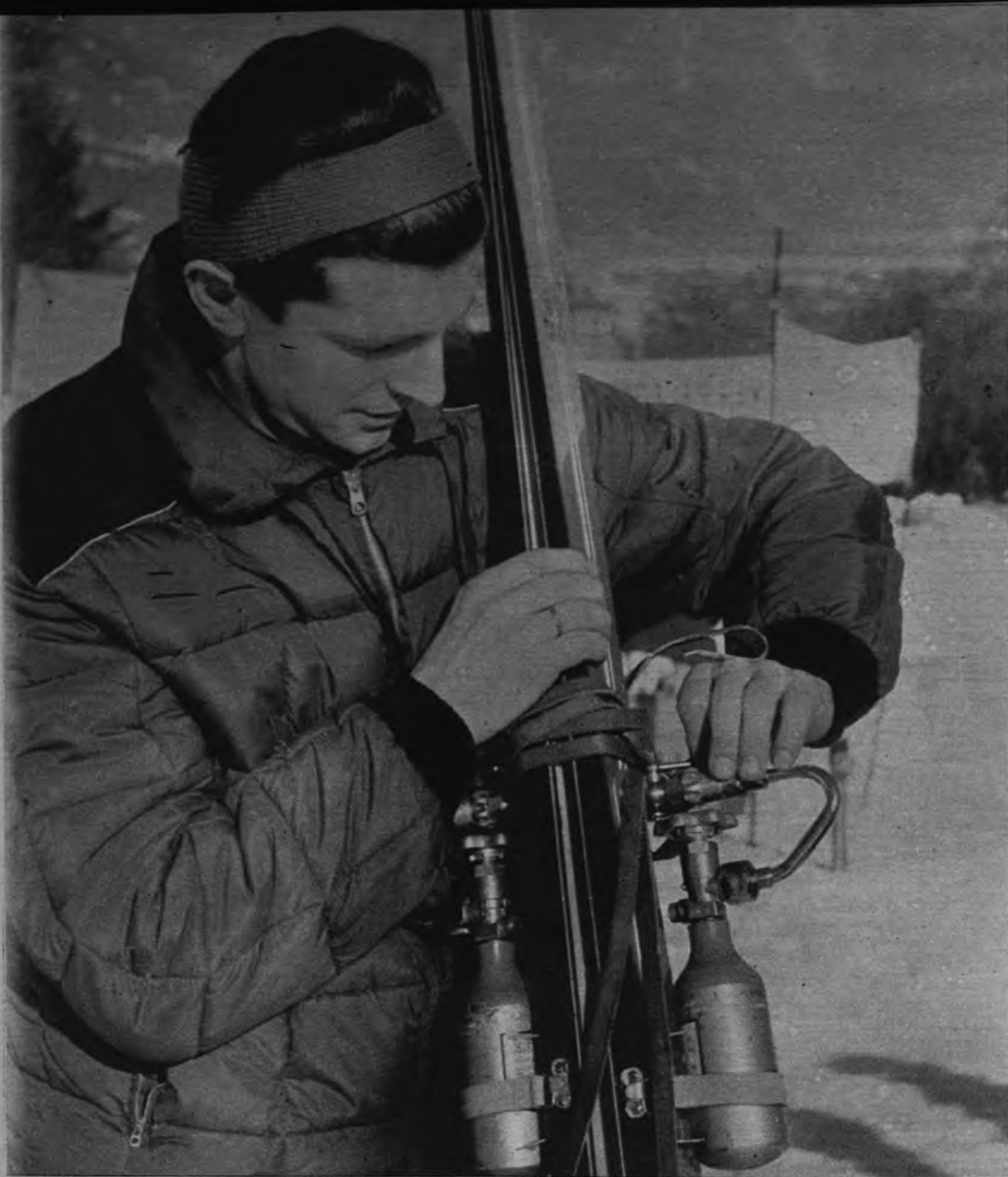
LA TECNICA Y LOS ESQUIS. —Johann Zopf, conocido esquiador, muestra el nuevo modelo de esquís en los que la técnica viene a jugar una baza a favor de la velocidad. Están accionados por botellas de aire a presión.—(Fotografía Cifra.)
