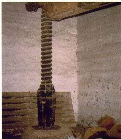
Husillo del molino de aceite de «Las Teresas» de Fuente Palmera (Córdoba)
