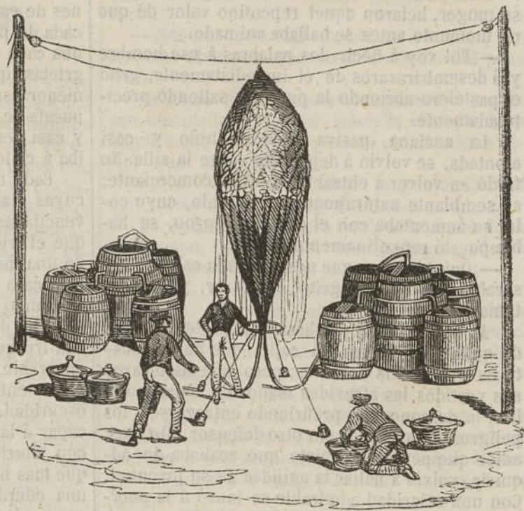
Modo de llenar un globo con gas hidrógeno.
