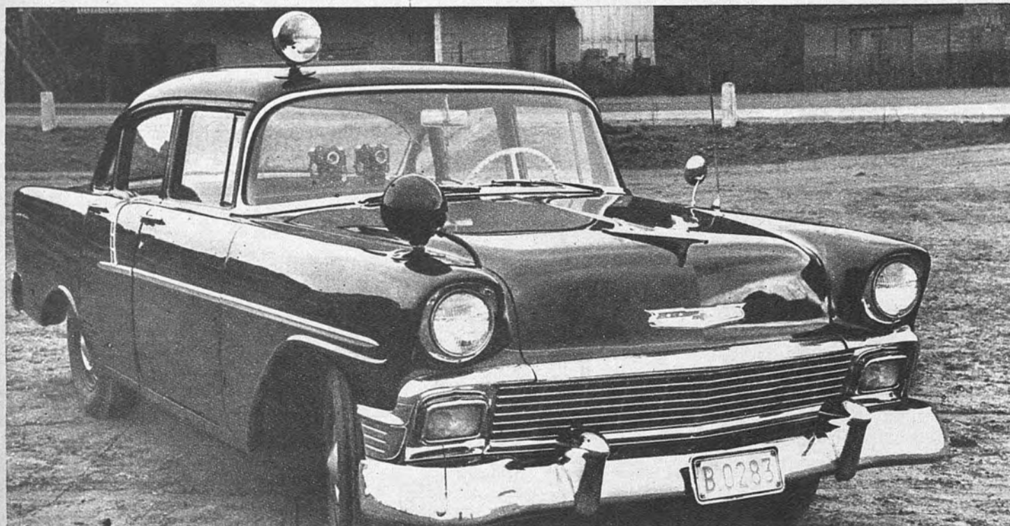
LA FOTOGRAFIA, AGENTE DE CIRCULACION. —La Policía berlinesa encargada de vigilar, regular y sancionar el tránsito rodado ha sido provista del vehículo que aquí podemos contemplar. El coche va provisto de dos cámaras fotográficas, una normal y otra con teleobjetivo. Ambas responden al
