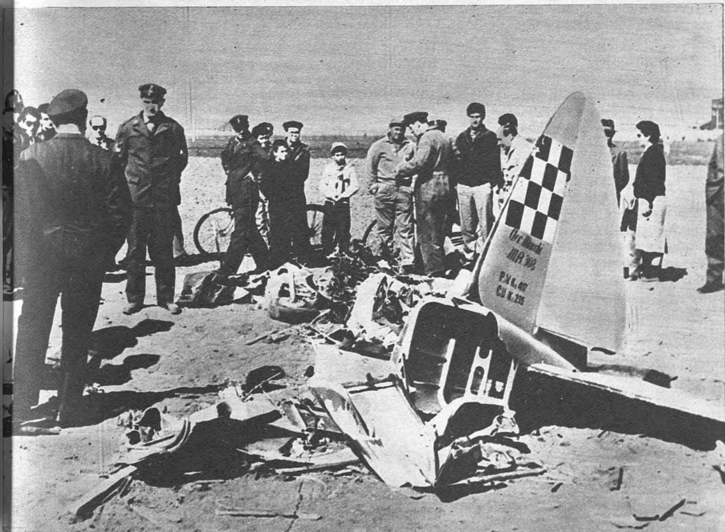
EL APARATO DESPEGO SIN TRIPULACION. —Aquí aparecen los restos del «Machi 308», que despegó sin tripulación del campo de Ferrara. Mientras el mecánico comprobaba el motor, el avión se elevó y voló 40 minutos
