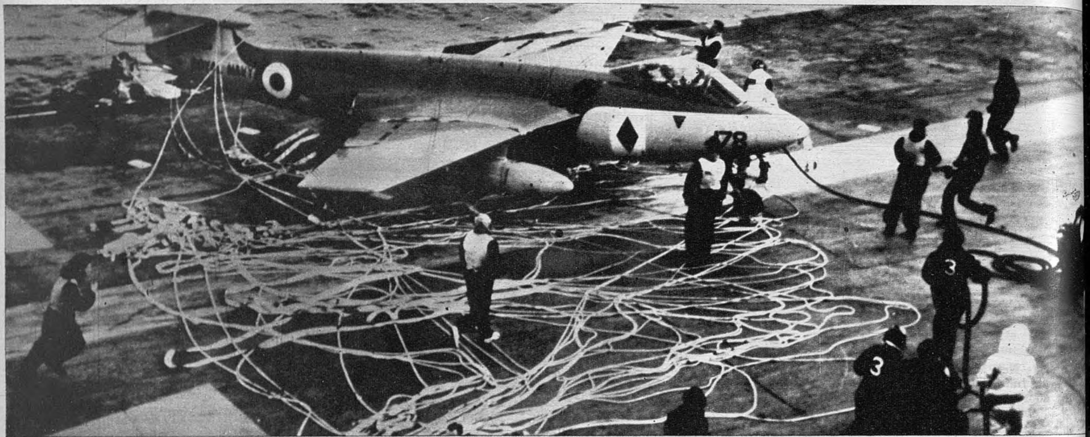
LA RED DE SALVACION. —Aterrizar, si así puede decirse, sobre la limitada cubierta de un portaaviones exige pericia y técnica, no es cosa fácil. Más de uno y de dos aviones han ido al agua, pese a las previsiones tomadas. Para evitarlo surgió un nuevo medio protector: la «tela de araña». El nylon forma una tupida y fuerte red que permite que el avión que toma mal la maniobra y corre el riesgo de zambullirse en el mar quede atrapado en su
