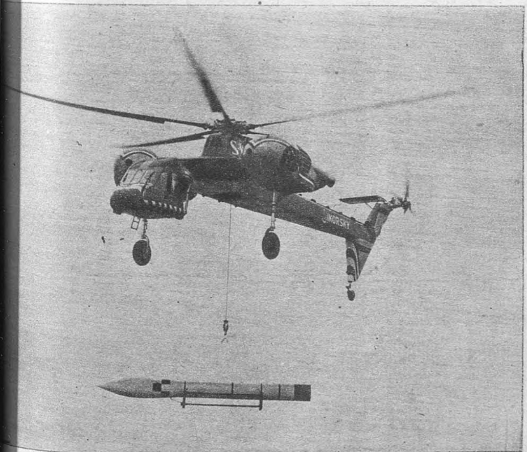
HELICOPTERO-GRUA. —El helicóptero-grúa «Sikorsky S-60», que transporta una carga de seis toneladas a 160 kilómetros, se eleva con un modelo de proyectil en un vuelo de pruebas efectuado en Stratford, Connecticut
