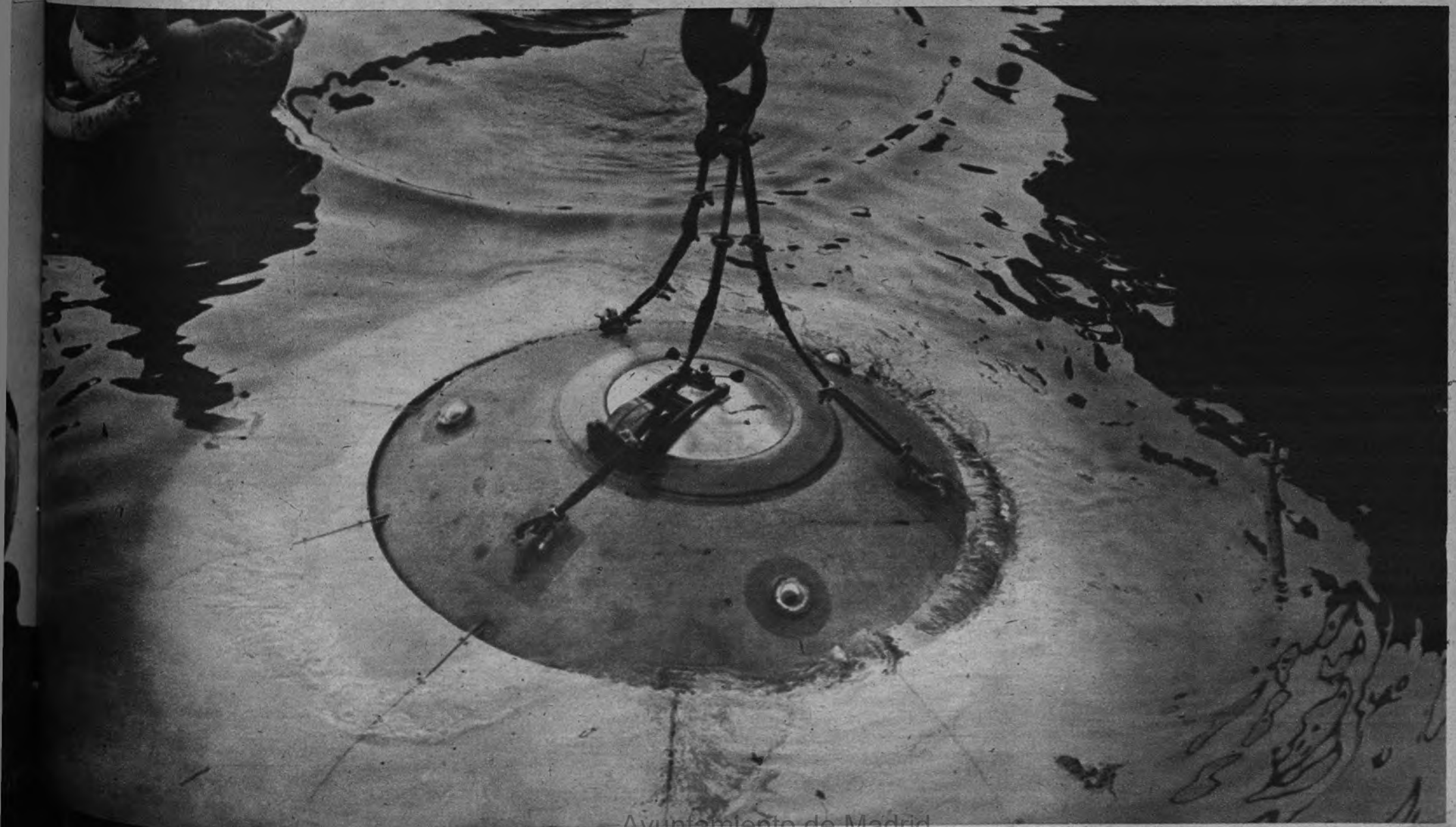
Cuatro años ha necesitado el comandante Cousteau para realizar su mágico proyecto, que pertenece ya al futuro de la técnica, pero cuya imagen corresponde con la de los animales prehistóricos. El platillo pesa tres toneladas y media y puede navegar a quinientos metros de profundidad a tres kilómetros a la hora, conduciendo en su interior durante veinte horas dos hombres echados. Los técnicos consideran que se trata de un instrumento muy útil para la investigación, ya que desde él se podrá filmar con la máxima comodidad las profundidades marinas y analizar la composición del fondo del mar. — (ARRIBA-«Paris-Match».)
