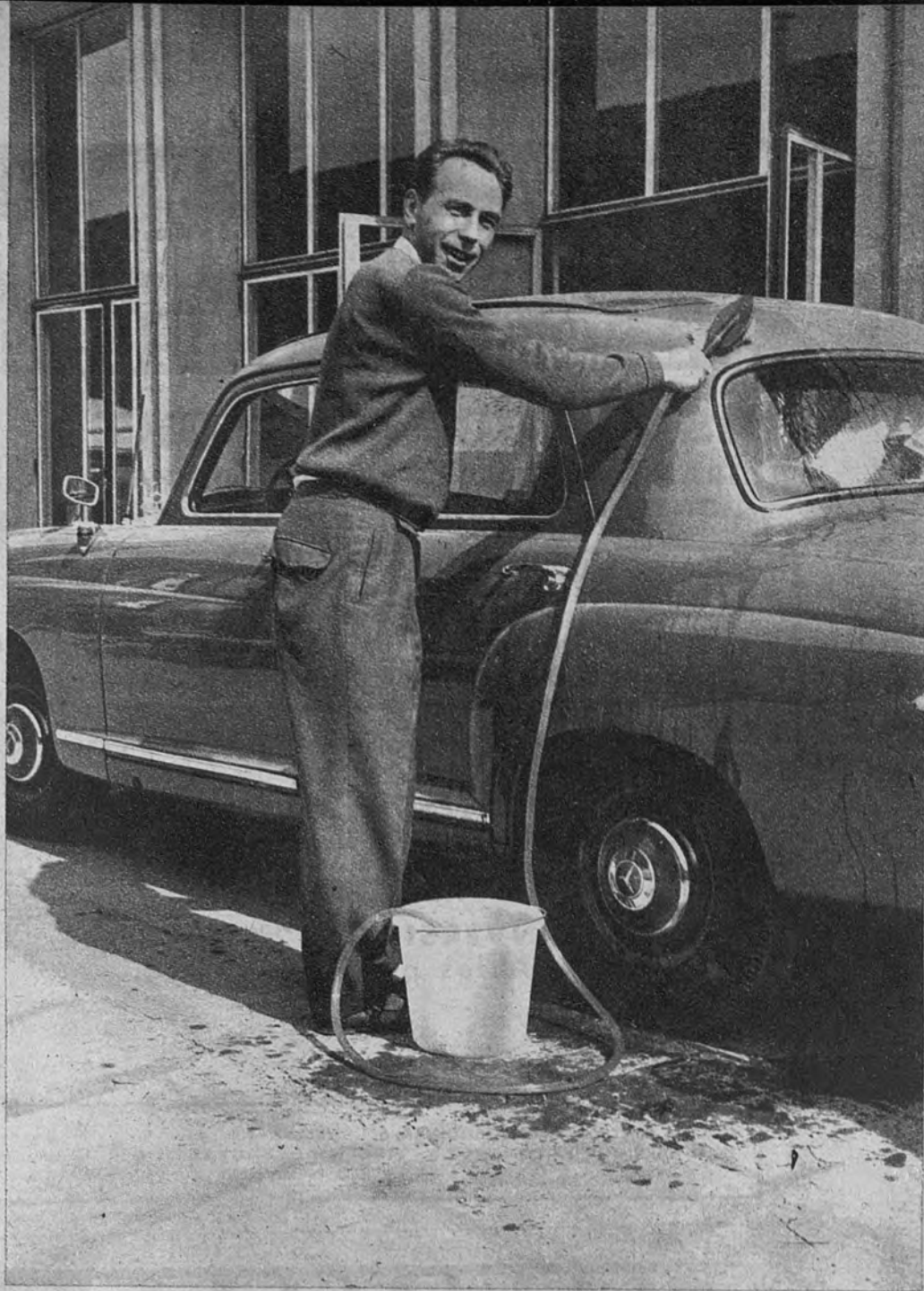
NUEVO SISTEMA DE LIMPIEZA. —En la Exposición del Automóvil, celebrada en Francfort, han presentado este sistema para el lavado de coches por medio de un cepillo conectado a un tubo que toma agua por absorción
