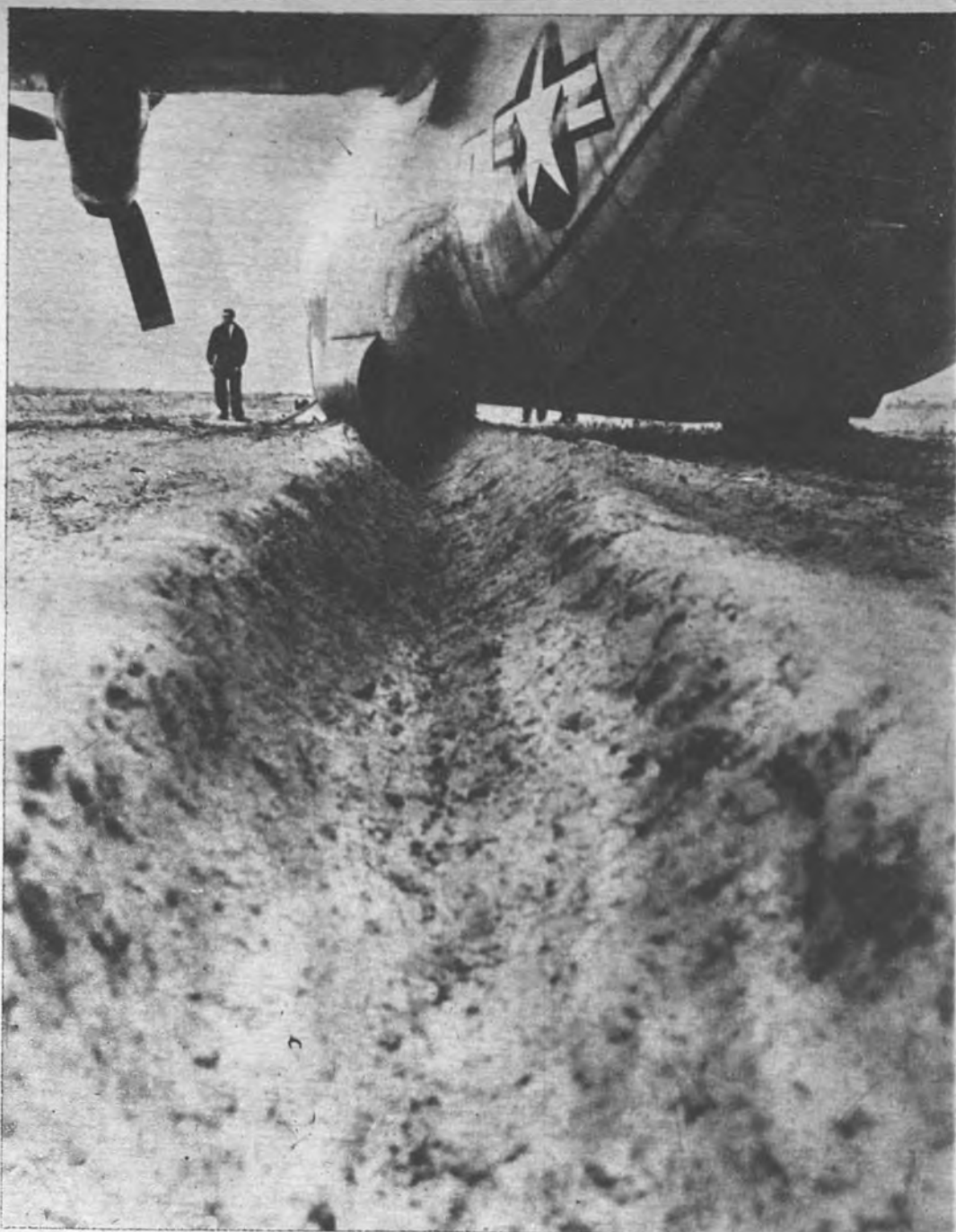
PUEDA ATERRIZAR EN CUALQUIER TERRENO. —Este es un aspecto del bajo fuselaje del avión "C-130" de transporte norteamericano, cuyo diseño permite el aterrizaje en cualquier clase de terreno aunque no disponga de pistas apropiadas
