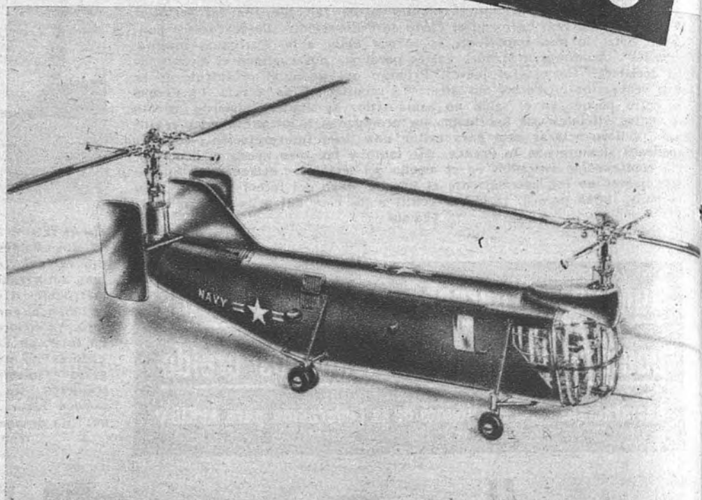
HELICOPTERO ANTISUBMARINO El dibujo corresponde a un nuevo tipo de helicóptero de la Armada de los Estados Unidos. Está diseñado especialmente para combatir a los submarinos, y en él puede observarse la disposición de las hélices delantera y trasera, cuyas grandes aspas giran con movimiento sincrónico. Es la última moda del rearme mundial. (Foto Reuter.)
