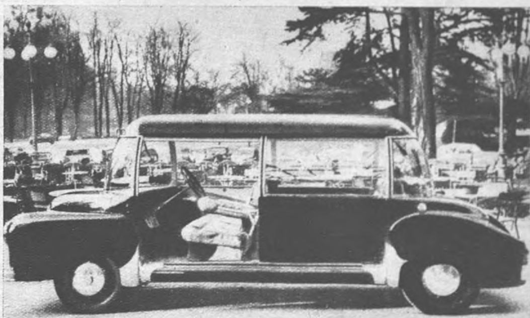
MODA AUTOMOVILISTICA Este nuevo coche francés se llama «Simétrico», tiene la carrocería transparente y su motor es de cuatro cilindros y 1.200 c. c. Va colocado en un generador de electricidad que acciona cuatro motores eléctricos colocados sobre las ruedas para eliminar la transmisión. El freno es eléctrico y el techo se descapota fácilmente
