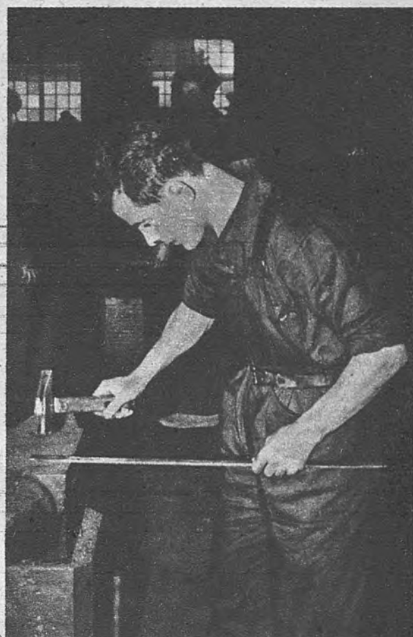
FORJADO. —Sobre el yunque reposa la punta del hierro a la temperatura deseada. La varita mágica del martillo dará la forma buscada
