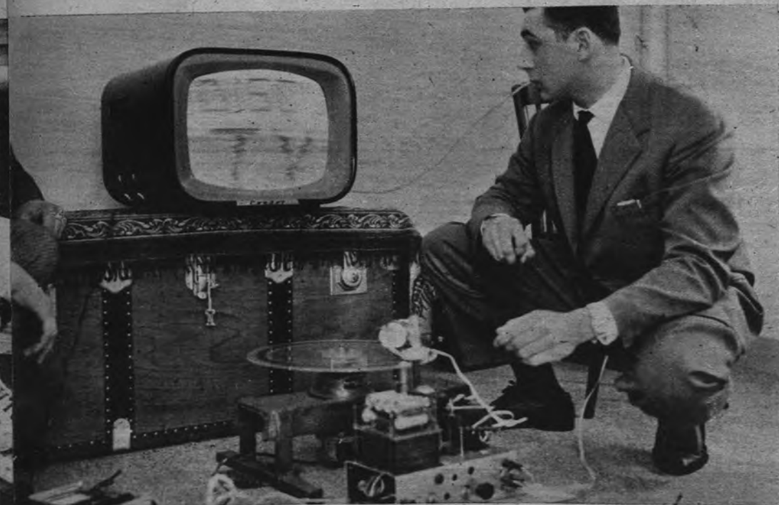
NUEVO INVENTO. —Antonio Rubbiani, italiano, ha inventado este aparato. Se trata de un disco fotográfico que, conectado con un receptor de TV, permite la transmisión a éste de las figuras impresionadas en el disco.—(Foto Cifra.)
