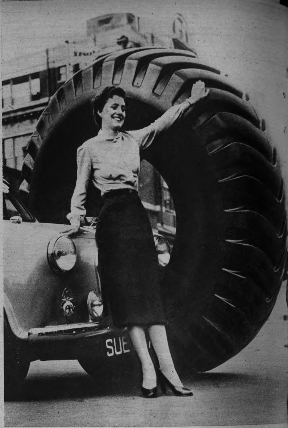
RUEDA GIGANTE. —El morro del automóvil y la estatura delicada de Pamela sirven para ver la proporción de esta cubierta, la mayor fabricada hasta ahora en Inglaterra. Contiene 300 millas de fibras de nylon y mide dos metros de diámetro
