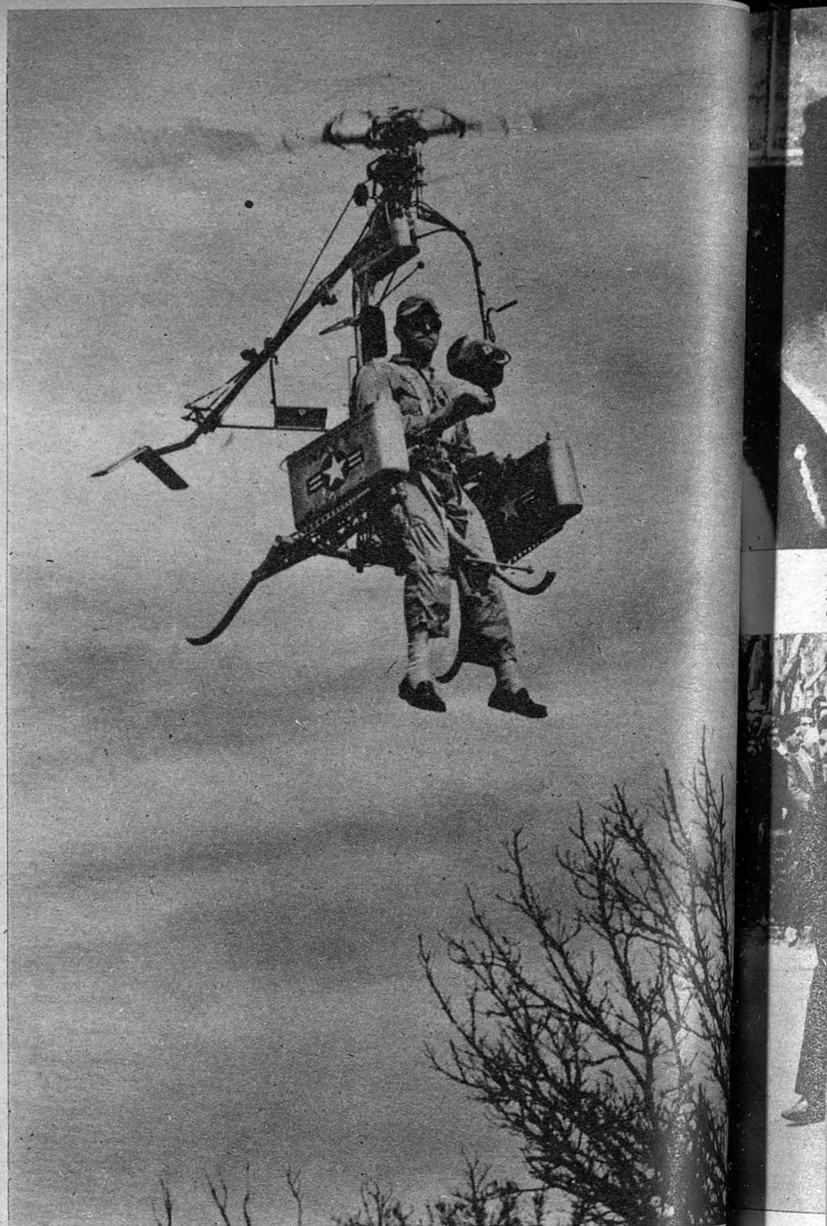
HELICOPTERO DE BOLSILLO.—Este es el más pequeño y rápido helicóptero que hasta ahora ha sido utilizado por el hombre. Es monoplaza, y aquí aparece en pleno vuelo. Como tren de aterrizaje el piloto deberá utilizar sus propios pies
