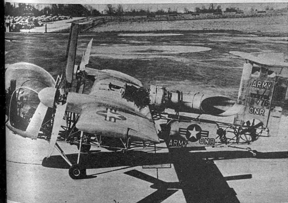
AVION-HELICOPTERO. —Acaba de construirse este tipo de avión de alas plegables, destinado a la Marina de EE. UU. La hélice de este nuevo tipo de aparato volador es cambiabile, de tal modo, que puede quedar arriba, como un helicóptero, o bien en posición delantera como un aparato corriente. Las fotos que publicamos ofrecen dos aspectos del aparato: La primera, la hélice está colocada normal, y en la segunda, las alas se han plegado y la hélice sube a la manera de helicóptero
