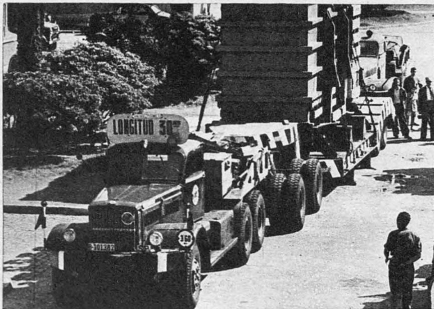
Gigantesco auto-tren de transporte cargado con un transformador de 107 toneladas, a su paso por las calles de Barcelona
