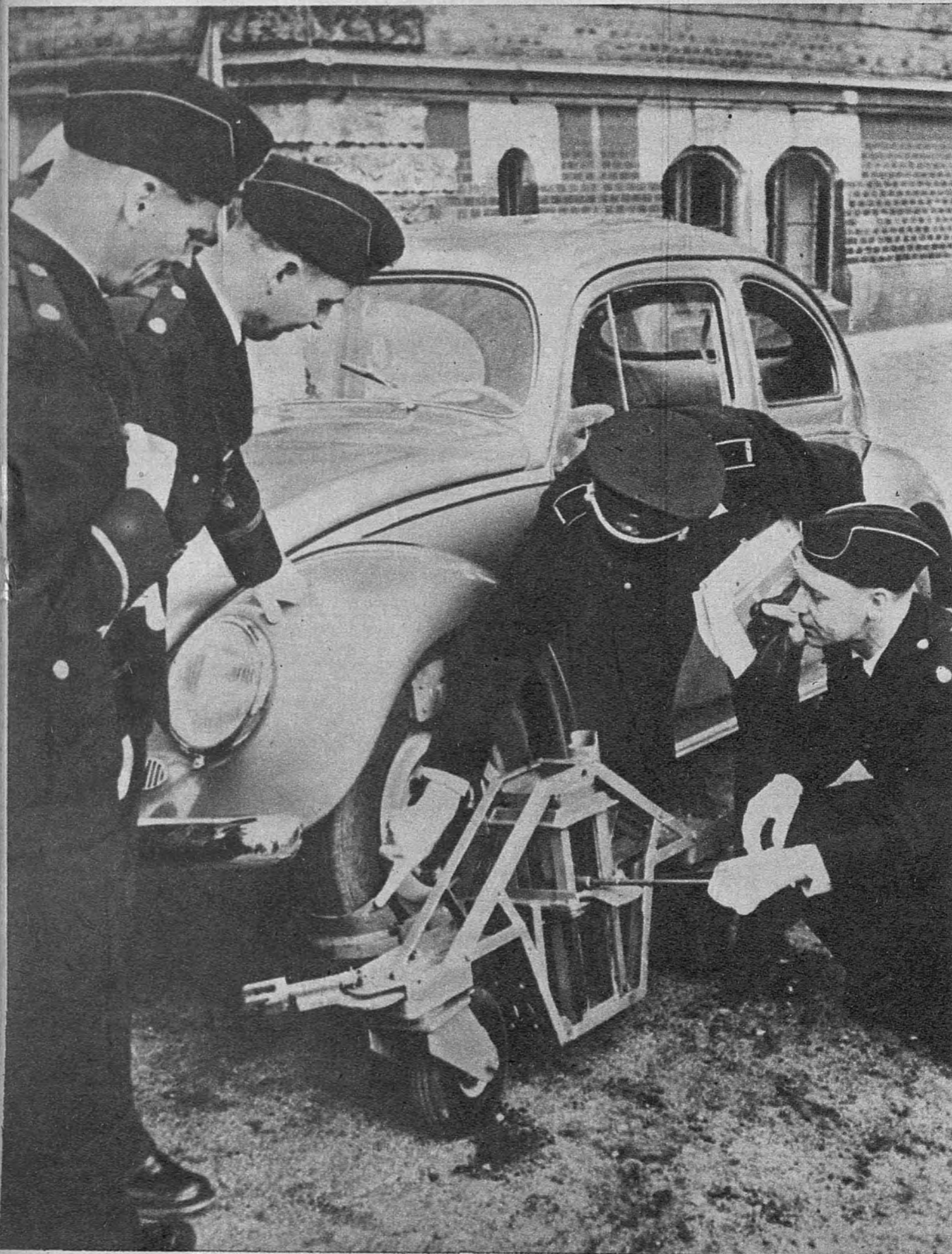
ESTACIONAMIENTO PROHIBIDO. —En Alemania, cuando el coche queda estacionado donde no debe, ocurre que llega la Policía federal y monta las ruedas del auto sobre esos aparatos que se ven en la foto. Luego empujan aparatos y vehículo hasta un depósito, en donde el dueño deberá pagar traslado y multa.
