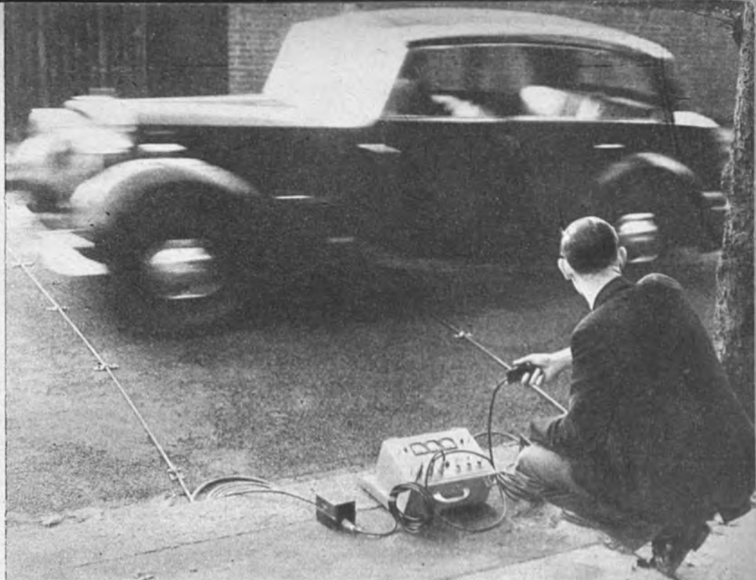
PARA VIGILAR LA VELOCIDAD. —La Policía inglesa ensaya actualmente un nuevo aparato electrónico que permite vigilar la velocidad de los automovilistas. La máquina dará origen a algunas multas y quizá evite algún que otro accidente
