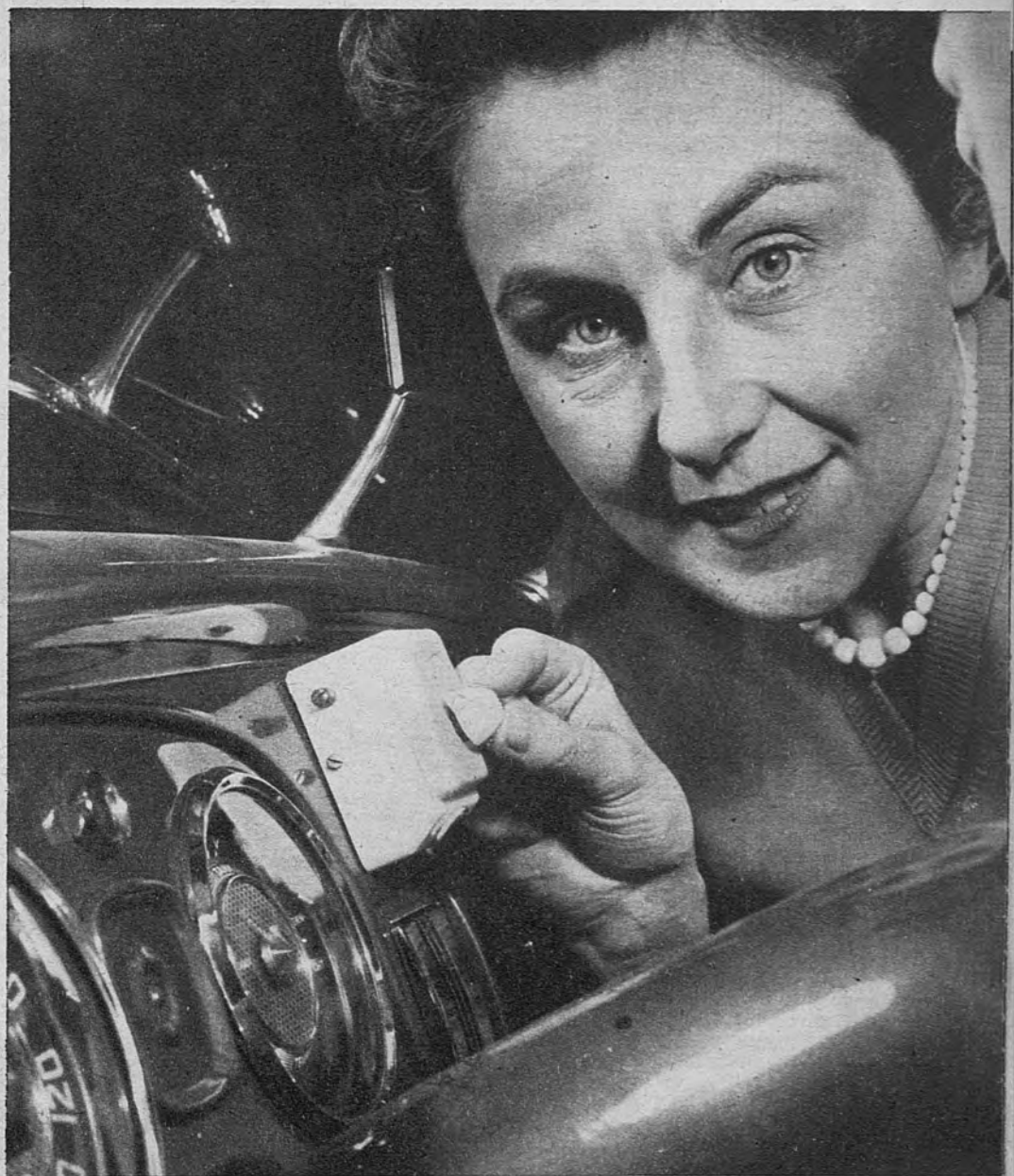
CONTRA LA IMPRUDENCIA. —Una firma de motores de Francfort ha ideado este cuentavelocidades para aviso de aficionados a la locura. Al sobrepasar un prudente límite de velocidad emite señales acústicas como despertador de alarma
