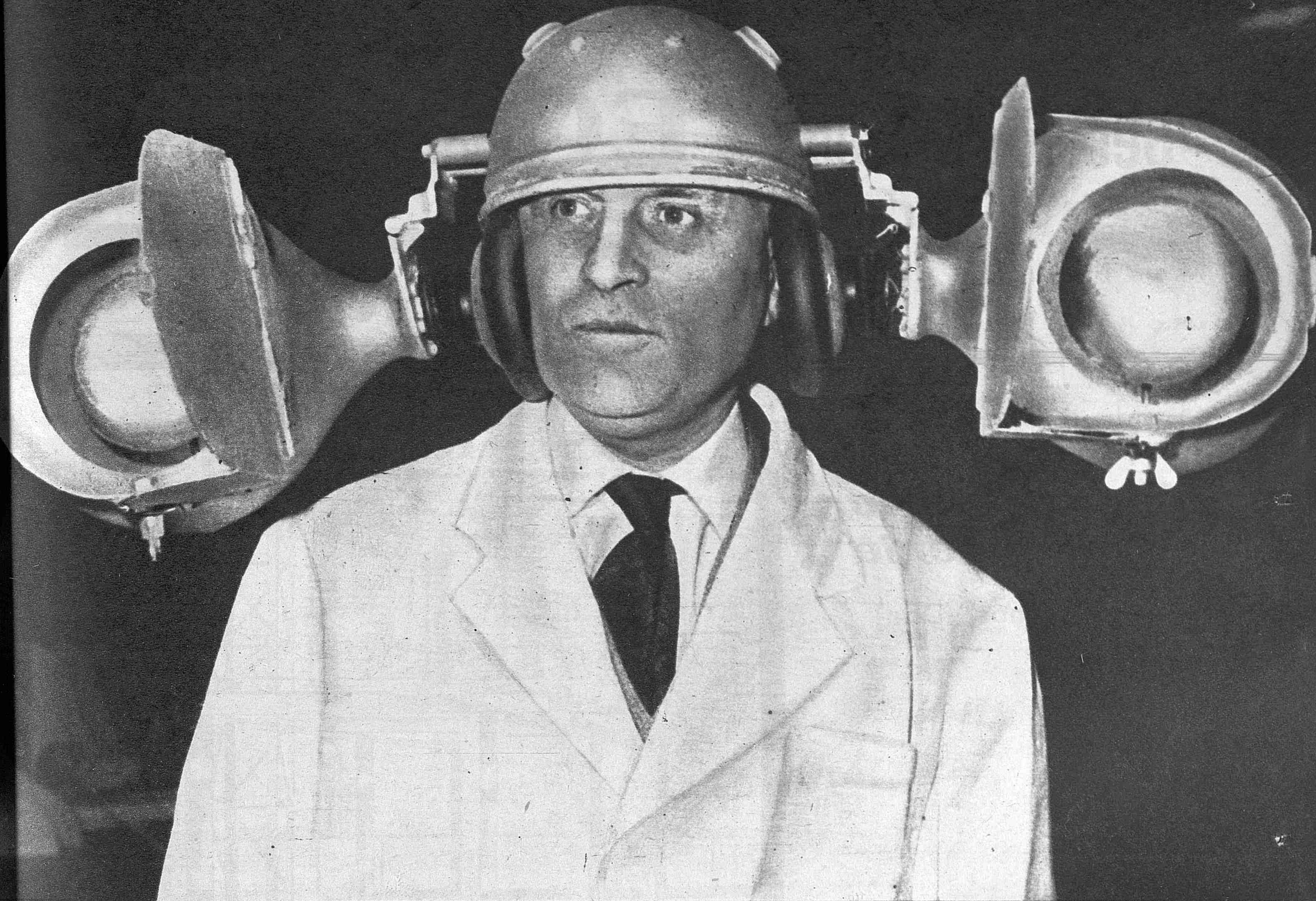
ESPECIAL PARA PESCADORES Y CAPITANES DE YATE. —Cuando hay niebla y el radar no puede actuar con eficacia en su misión de centinela alerta, resulta excepcional el servicio que puede prestar este extraño casco que aquí se muestra. Se trata de un detector de señales que permite localizar los ruidos emitidos por barcos, evitando colisiones. El casco ha sido presentado en el Salón de Inventores de Bruselas por Jean Auscher.—(Foto Fiel.)
