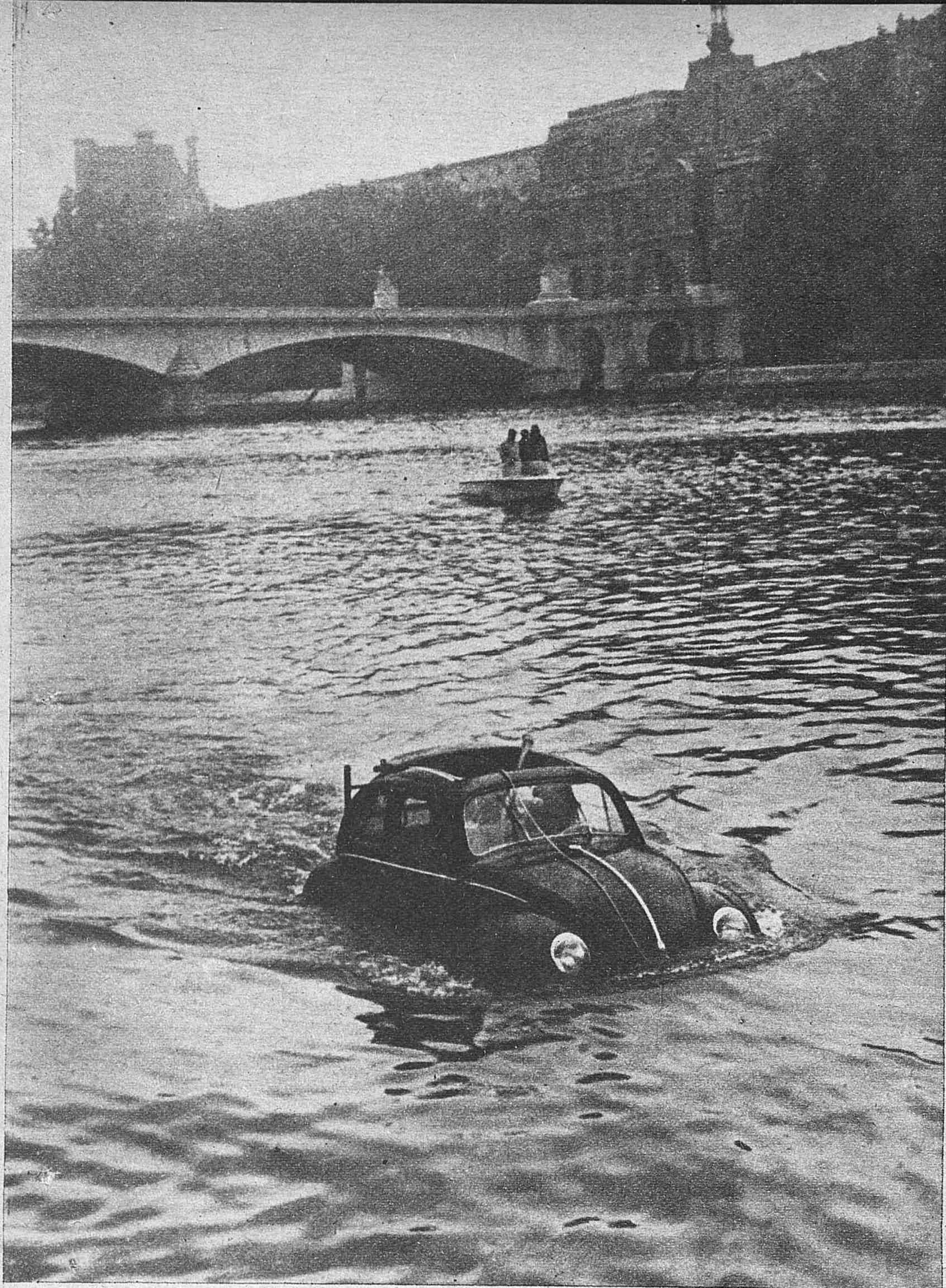
«VOLKSWAGEN» FLUVIAL.—Bajo los puentes del Sena, un «Wolkswagen» normal, provisto de una carrocería impermeabilizada y de una hélice «de río», navega en un viaje experimental con vistas a un nuevo modelo anfíbio
