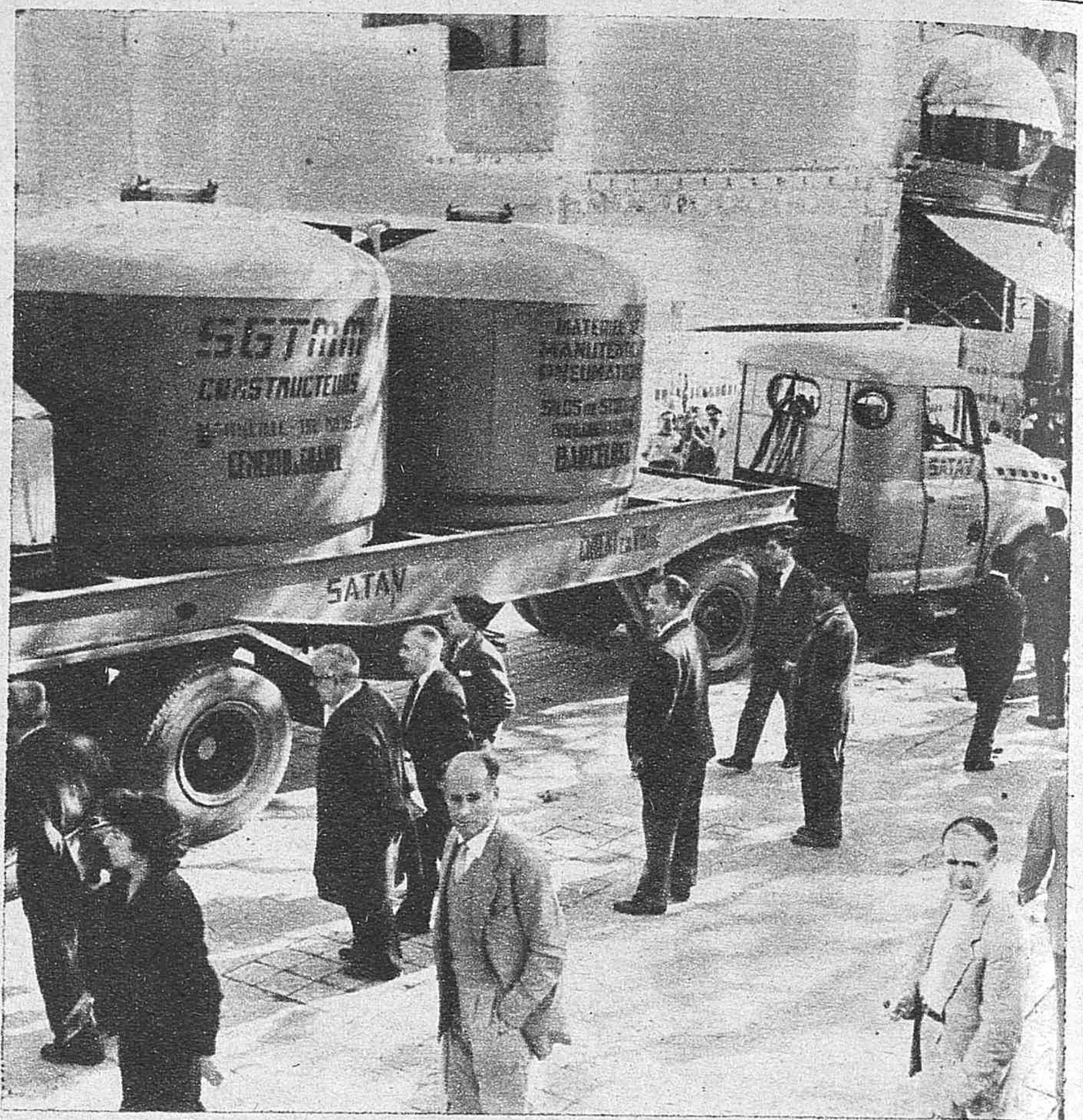
DESCARGA ESPECIAL DE CEMENTO EN BARCELONA. —En plena Plaza de Cataluña, en el local donde se alzará "El Corte Inglés", se ha hecho una demostración de descarga neumática de cemento por un procedimiento patentado y que va a revolucionar el actual sistema de transvase, ya que parece que equivale a un ahorro muy superior al 25 por 100 del coste actual. La entidad demostradora la S. G. T. M. M. Española, hizo venir para ello este "container" de la casa matriz de Marsella. —(Foto Cifra.)
