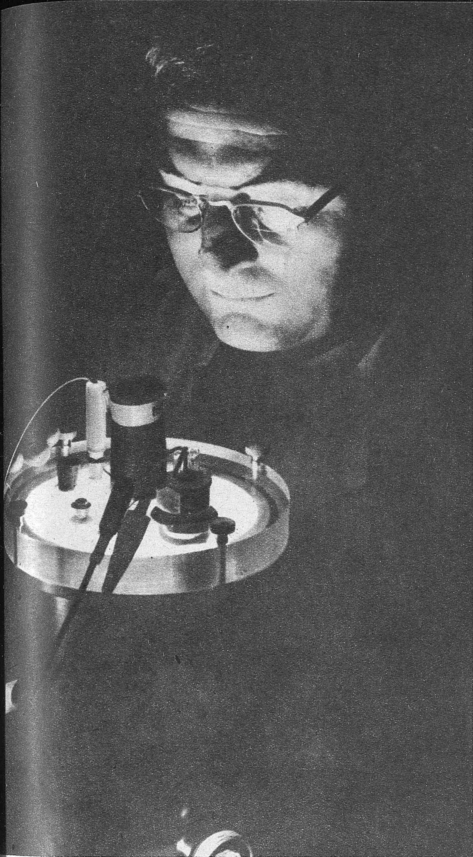
UN METRO BIEN MEDIDO. —La barra de platino, que antes era la medida del metro, ha sido sustituida por otra más exacta: «la longitud de onda de la luz naranja emitida por el elemento krypton». Esta es su lámpara en ajuste
