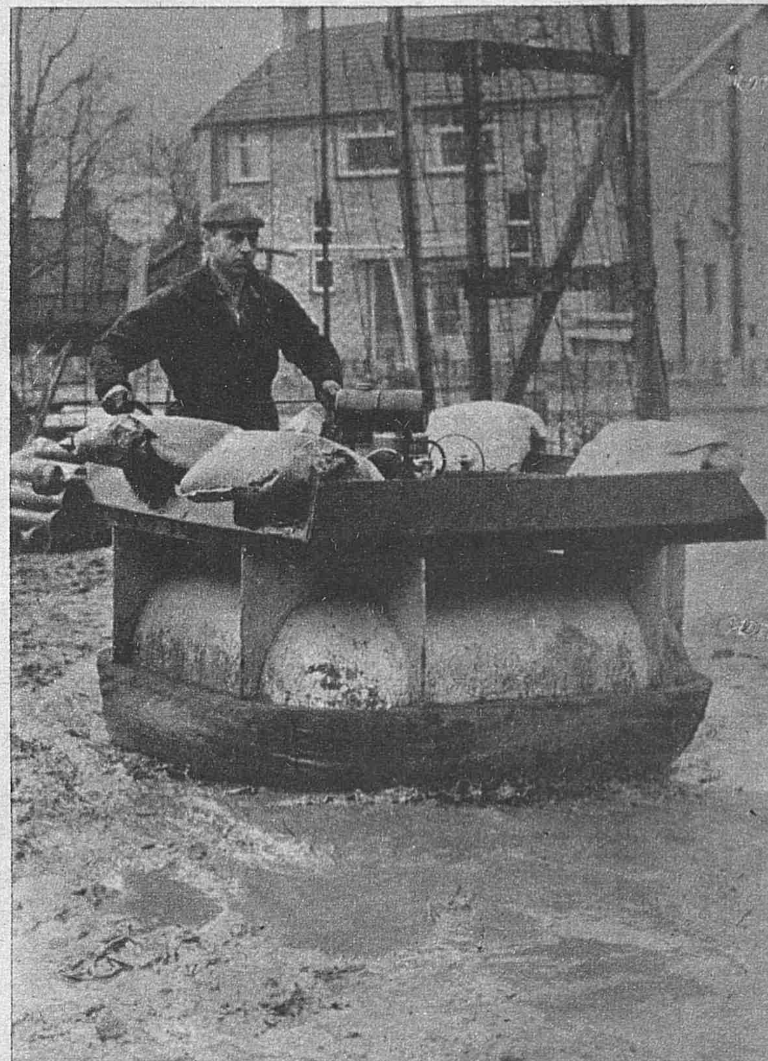
ESPECIAL PARA ZONAS CENAGOSAS Y DE LODO. —El barro, el lodo, cualquier obstáculo de esta clase, no impide la marcha de este vehículo británico, construido especialmente para acarreo de materiales en esas zonas.
