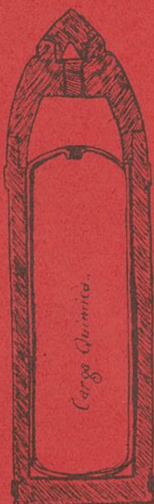
Fig. 7.—Proyectil de Artillería cargado con agresivo químico. La carga química va en un depósito y no está en contacto con las paredes del proyectil.
