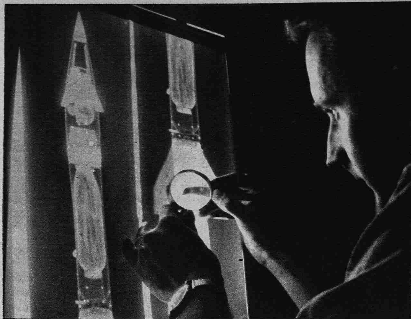
Los proyectiles, al igual que le ocurre al cuerpo humano, necesitan ser examinados ante la pantalla de los rayos X para descubrir cualquier enfermedad, es decir, un posible defecto de fábrica
