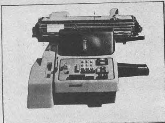
AUDIT 623 - Máquina contable numérica con tres totalizadores y perforador de cinta numérico.
