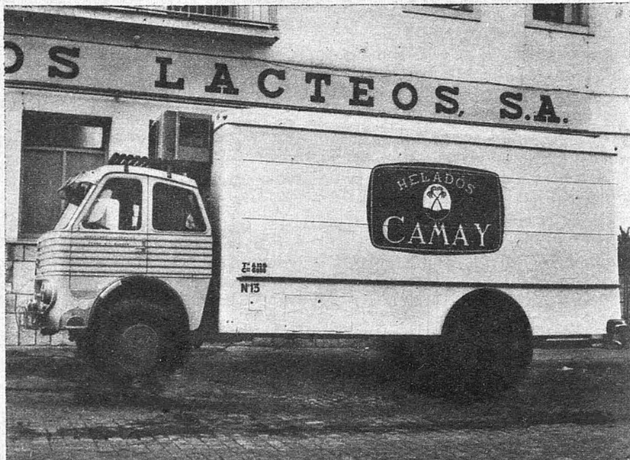
Uno de los camiones frigoríficos de la Empresa destinado a la exportación de los productos a provincias y dotado de unidad de refrigeración automática Thermo-King
