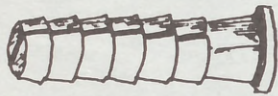
LA OTRA FIGURA, BIEN CONOCIDA ES LA DEL TACO ESTRIADO DE POLIETILENO, CARACTERISTICO POR SU GROSOR Y SU COLOR BLANCO.
