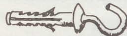
OTRO ELEMENTO DE FIJACION UTILISIMO ES EL CONJUNTO TACO - HEMBRILLA O, TACO - ALCAYATA O, TACO - TORNILLO. PUEDE ENCONTRARSE EN DOS LONGITUDES DIFERENTES Y DIVERSAS FORMAS. INDISTINTAMENTE PARA PARED O TECHO.
