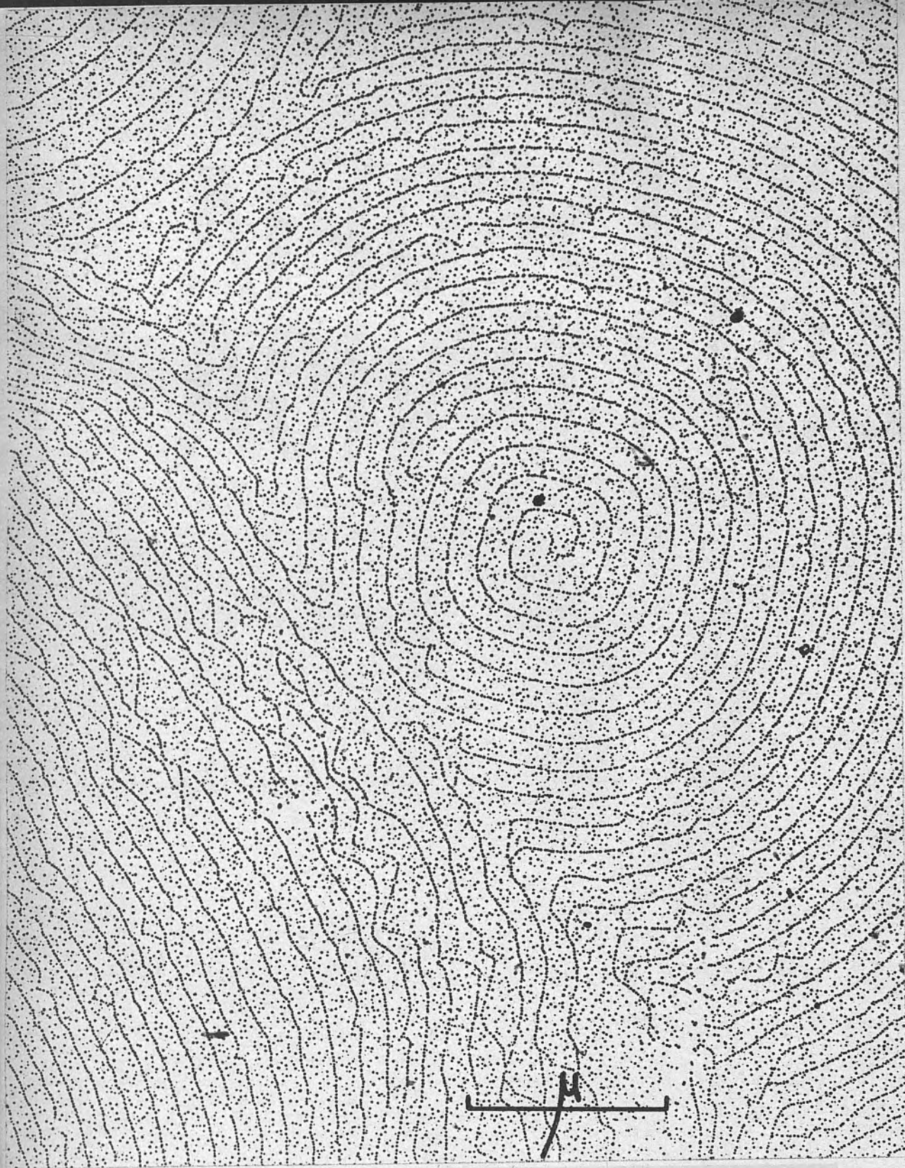
Observación de dislocaciones en Na Cl por el método de decoración. Electromicrografía realizada en el PHILIPS E. M. 200 a 5.000 x. (Doctor don José SERNA ALCARAZ.)—A la derecha, tejido sexual embrionario. La flecha señala el núcleo celular, y el asterisco la zona de unión entre dos células. Electromicrografía realizada en el ZEISS E. M. 9 a 6.000 x. (Dr. GONZALEZ SANTANDER.)
