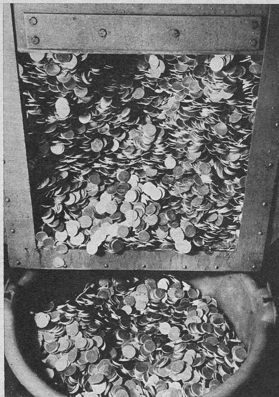
Salida de cospeles de las cubas de decapado
