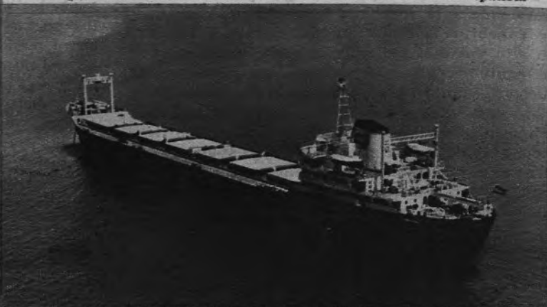
Bulk-Carrier "MINAS CONJURO", de 21.300 Tons. de P. M. y 15.000 T. M. de R. B., con motor propulsor de 7.300 BHP. Construido en Astilleros de Sevilla, de la Empresa Nacional ELCANO, para armadores nacionales
