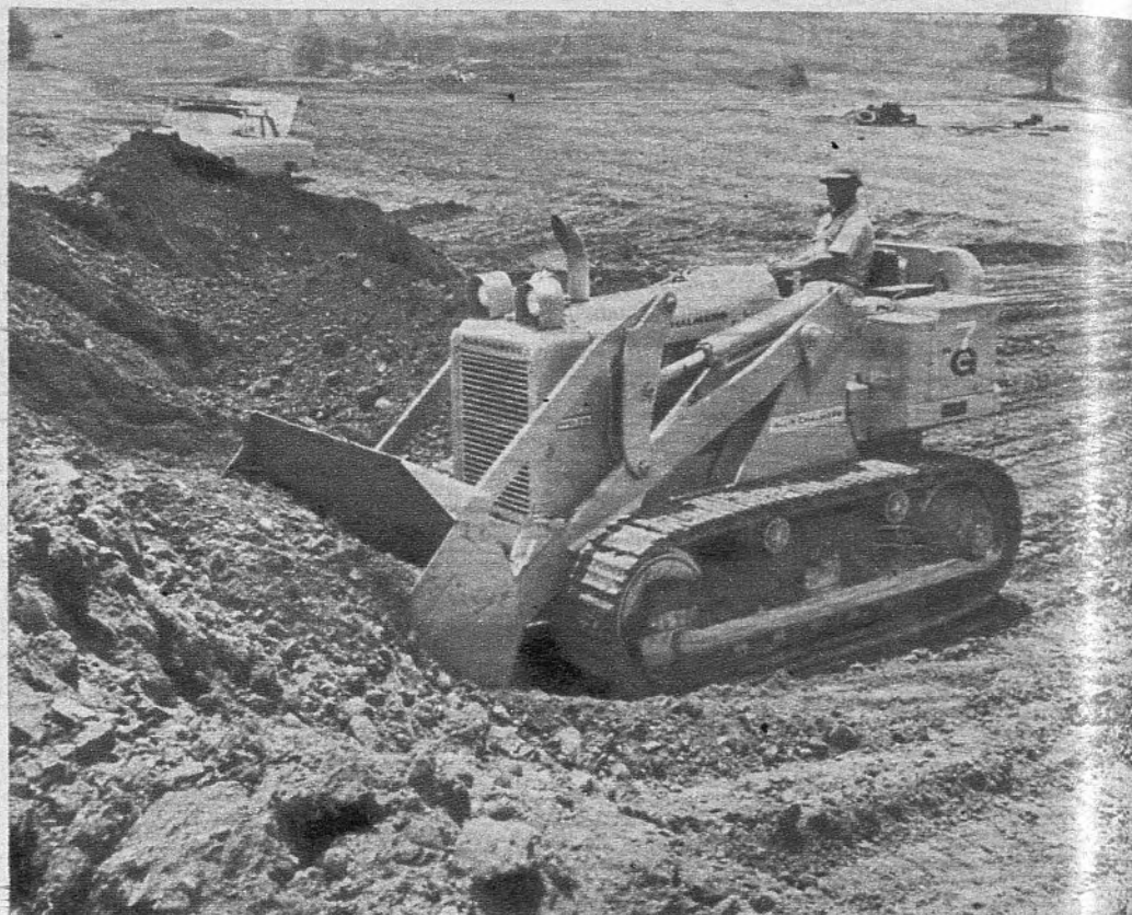
Pala Cargadora Oruga mod. HD-7G, de 107 CV., con cuchara de 1,34 metros cúbicos
