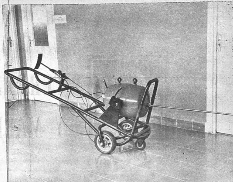
Cámara radiográfica para obtención de radiografías con fuentes de radioisótopos de elevada energía de rayos gamma
