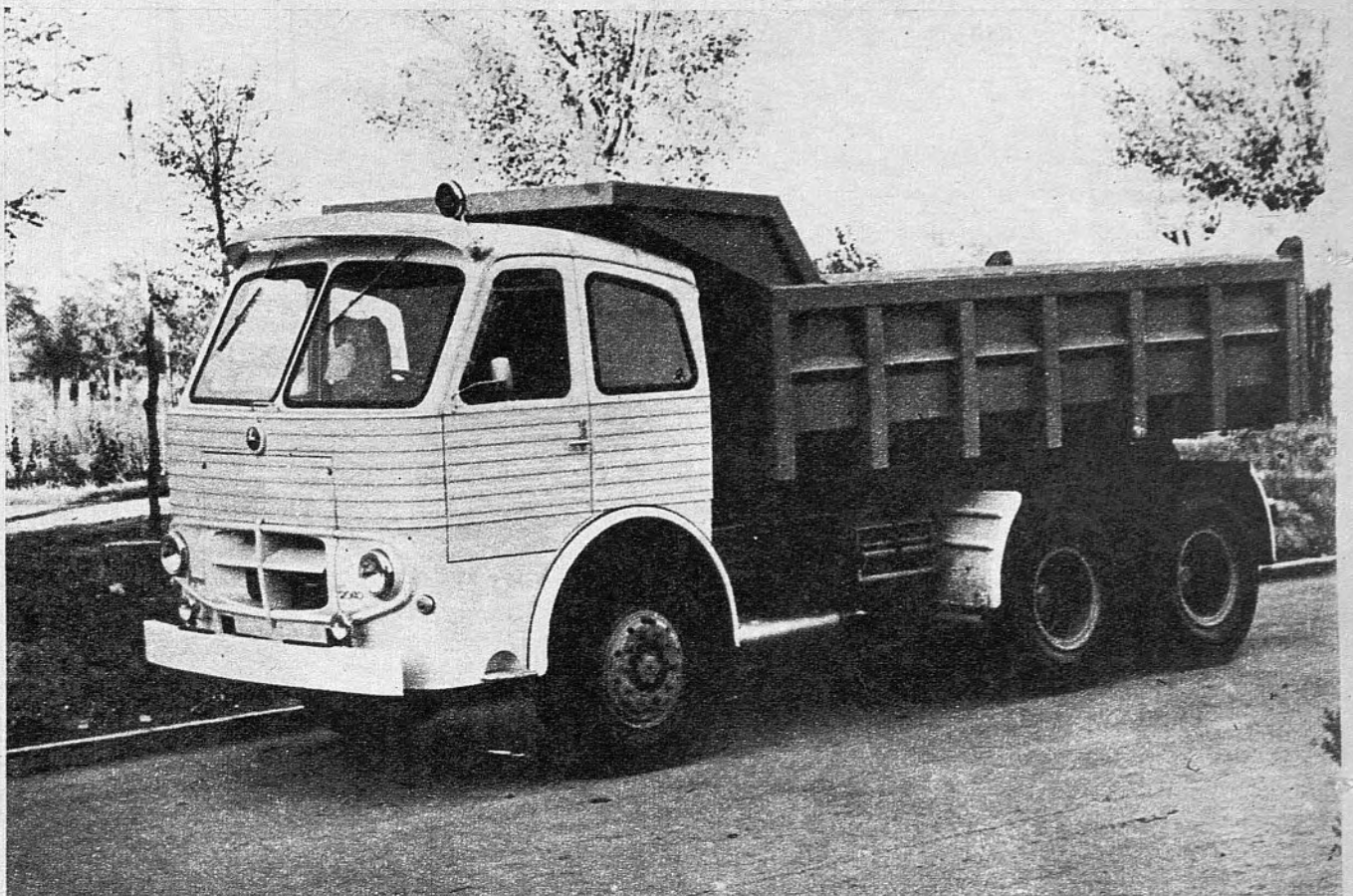
Camión «3060 D-Dumper», especialmente estudiado para el montaje de volquetes de gran capacidad y que también albergó Pegaso en el «stand» del reciente Salón de Barcelona como novedad de la firma.
