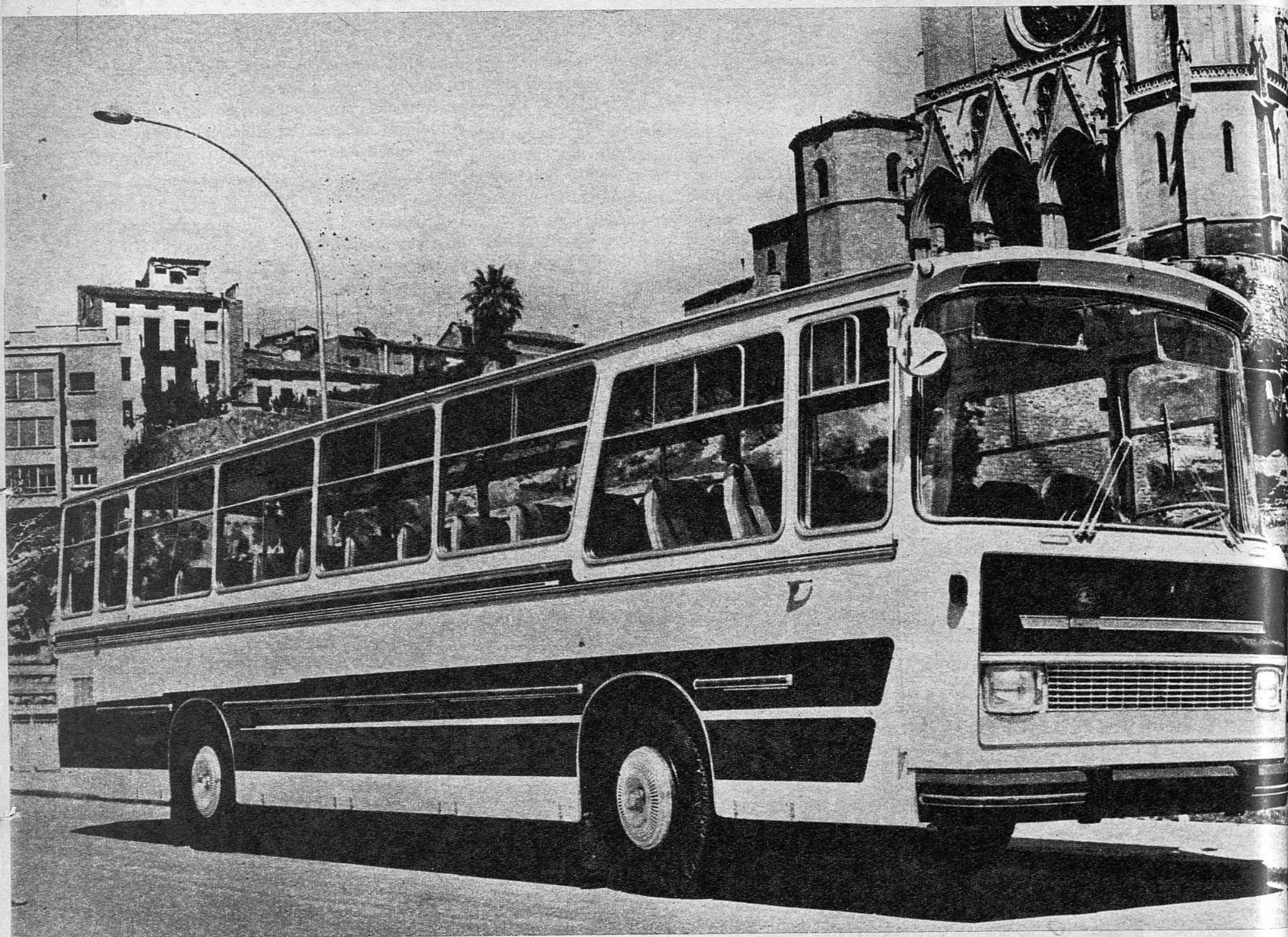
Autocar construido sobre «Pegaso 5031-L», de diseño sobrio y de línea moderna. Pese a la gran capacidad —57 plazas, más conductor y guía— se ha logrado dotar al vehículo de gran comodidad.
