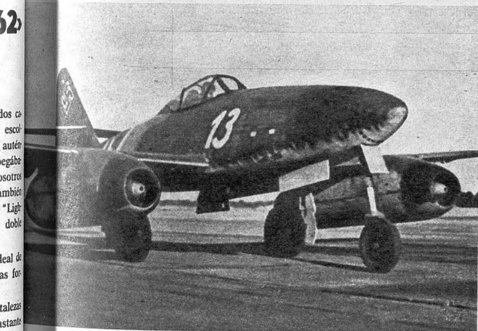
El «Messerschmitt 262». Se aprecian claramente los dos turborreactores. Cada uno de sus doce cohetes «R4M» bastaba para derribar un cuatrimotor. Volaba a 950 kilómetros por hora
