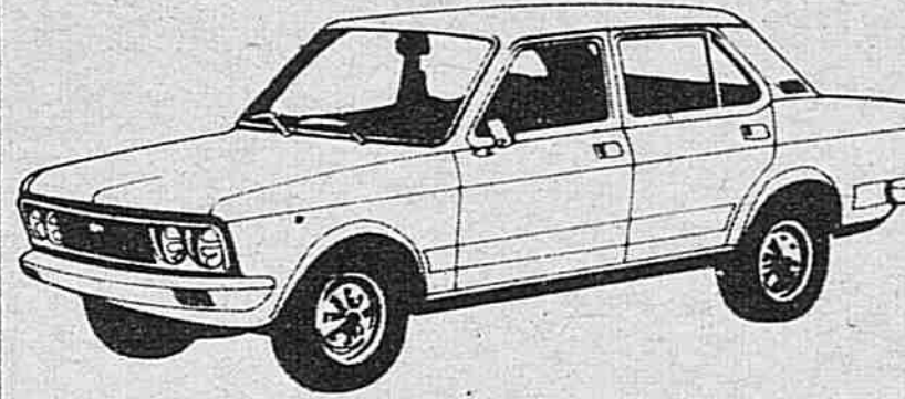
132-DIESEL 1.988 c. c. (55 CV. DIN) VELOCIDAD: 140 Km/h.
