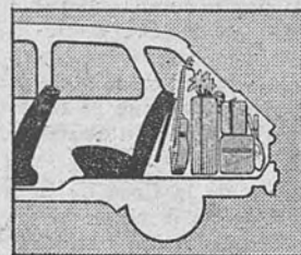
La bandeja trasera se abate aumentando la capacidad.
