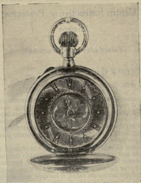
Uno de los relojes fabricados expresamente para ciegos, que marca las horas hundiéndose el punto que la indica, y los minutos por la posición de su manecilla única.
