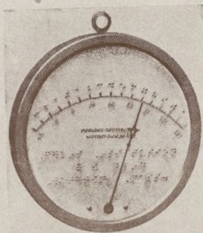
Termómetro adaptado para uso de los ciegos en grados Farenheit
