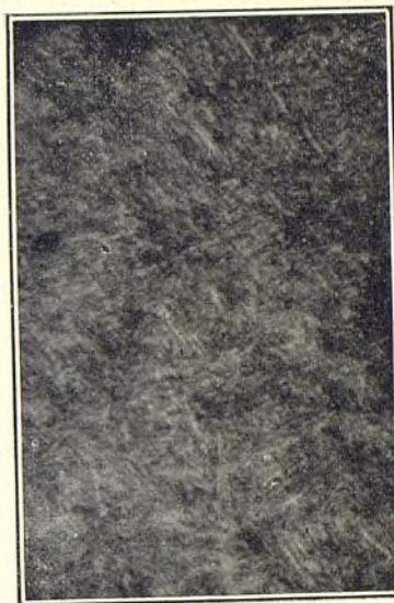
FIG. 5. a —Acero templado. Aumento: 650 diámetros.—Luz vertical.
