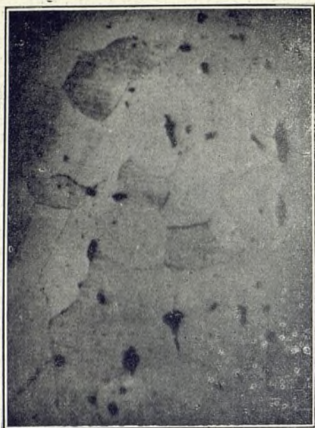
FIG. 1.—Hierro con 0,05 por 100 de carbón. Aumento: 100 diámetros.—Luz vertical.
