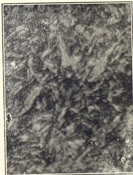
FIG. 6. a —Acero templado. Aumento: 650 diámetros.—Luz vertical.
