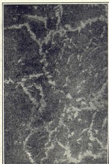
FIG. 10.—Acero forjado (1,30 por 100 de C) Aumento: 100 diámetros.—Luz vertical.
